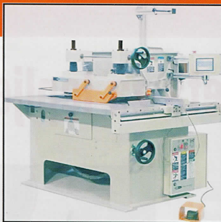
Slika 4: Kružna pila sa blanajućim rezom za pripremu masivnog drveta za lepljenje
