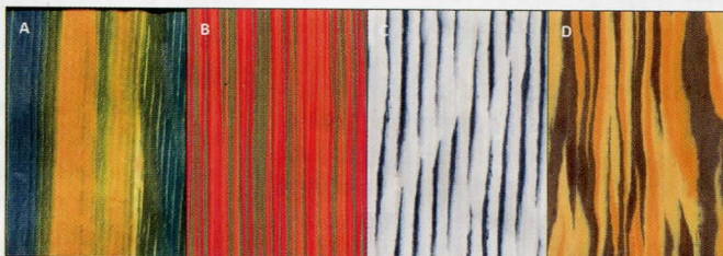
Slika 3: Furnir iz dubinski bojenog drveta (još u dubecem stanju); B,C,D- FineLine bojeni topolovi furniri
